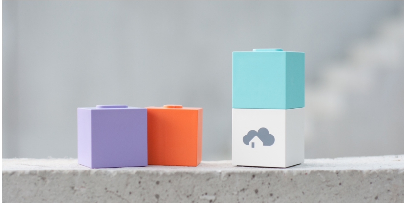
Abbildung 2.6: Homee Brain Cube (weiß), Z-Wave Cube (violett), ZigBee Cube (orange) und EnOcean Cube (türkis) [10]
